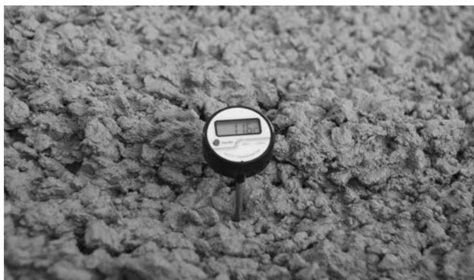
Bild 5: Messung der Frischbetontemperatur ( $T_L$ ) bei der Übergabe des Betons
