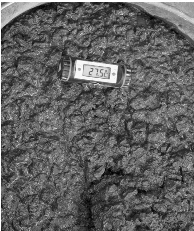
Bild 7: Vermehrte Kontrolle der Frischbetontemperatur auch nach Probekörperherstellung
